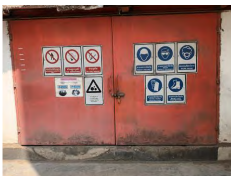
รูปที่ 2-83 ป้ายเตือนอันตราย และป้ายเตือนให้พนักงานสวมหน้ากากกันสารละลายอินทรีย์ในบริเวณที่กำหนด
