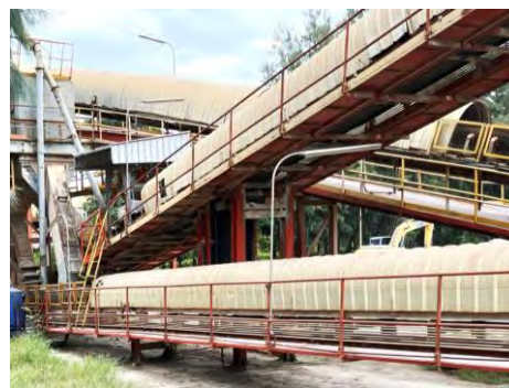
รูปที่ 2-5 การปิดคลุมบริเวณสายพานลำเลียงวัตถุดิบ ของโรงงาน 2
