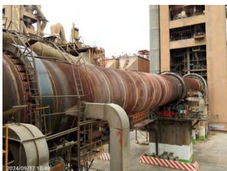
รูปที่ 2-37 เตาเผาปูนซีเมนต์ โรงงาน 2 และ 3
