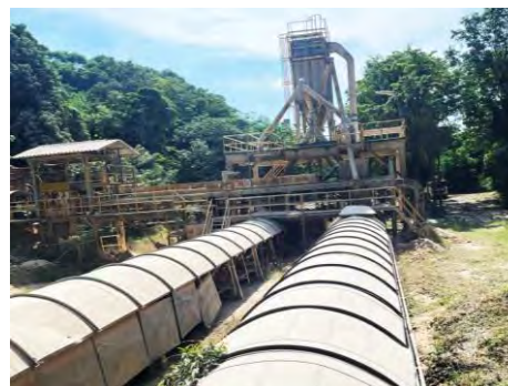
รูปที่ 2-3 เครื่องดักฝุ่นแบบ Bag filter
